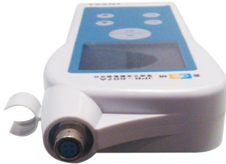
JPB-607A 型便携式溶解氧测定仪后视图（图 4）
