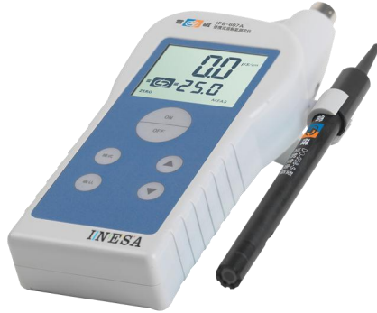
JPB-607A 型便携式溶解氧测定仪前视图（图 3）
